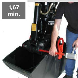
Rimuovere il perno di scambio con l'apposito utensile di estrazione.
