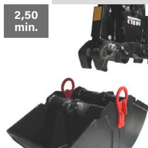
Posizionare il portante della benna sul nuovo accessorio e chiudere idraulicamente l'unità di blocco.
